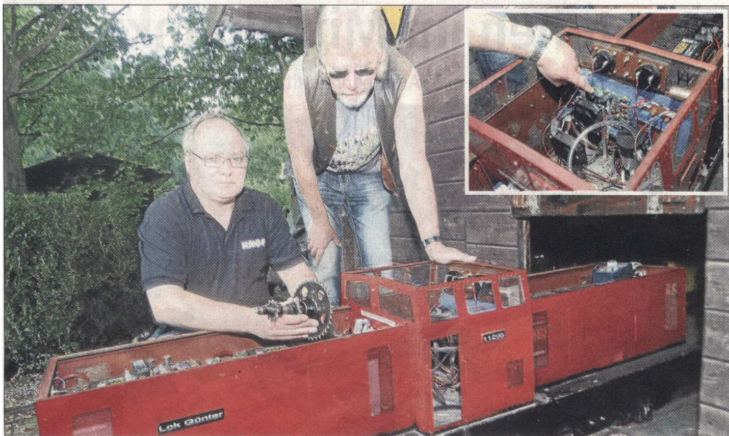
Andreas Siebert (links) zeigt dem Vorsitzenden Peter Göbel die Schwachstellen von „Lok Günter“. Die Steuerung etwa (kleines Foto) hat in den vergangenen Wochen versagt, ist zu heiß geworden. Eigentlich gehört sie zu einer Rollstuhlsteuerung, die allerdings seit Jahren schon nicht mehr hergestellt wird. Ersatzteile sind also Mangelware. ■ Fotos: Mroß
